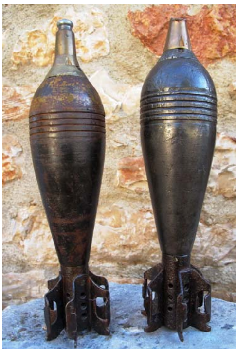
Granadas de mortero Brandt de 81 mm. izq con espoleta RyG, dcha con espoleta Raymond (ambas espoletas diseñadas por Rémondy). La imagen de la dcha vía http://materialguerracivil.forumup.es/
