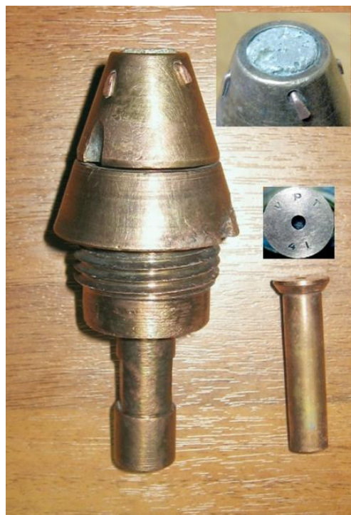
Arriba izquierda, espoleta para bombas de 10 y 50 kilos sistema RSA modelo 1928, derecha, bomba MAC francesa modelo 1927; abajo copia finlandesa de la espoleta RSA, denominada SR/33-23/31 (foto vía http://www.bocn.co.uk ).
