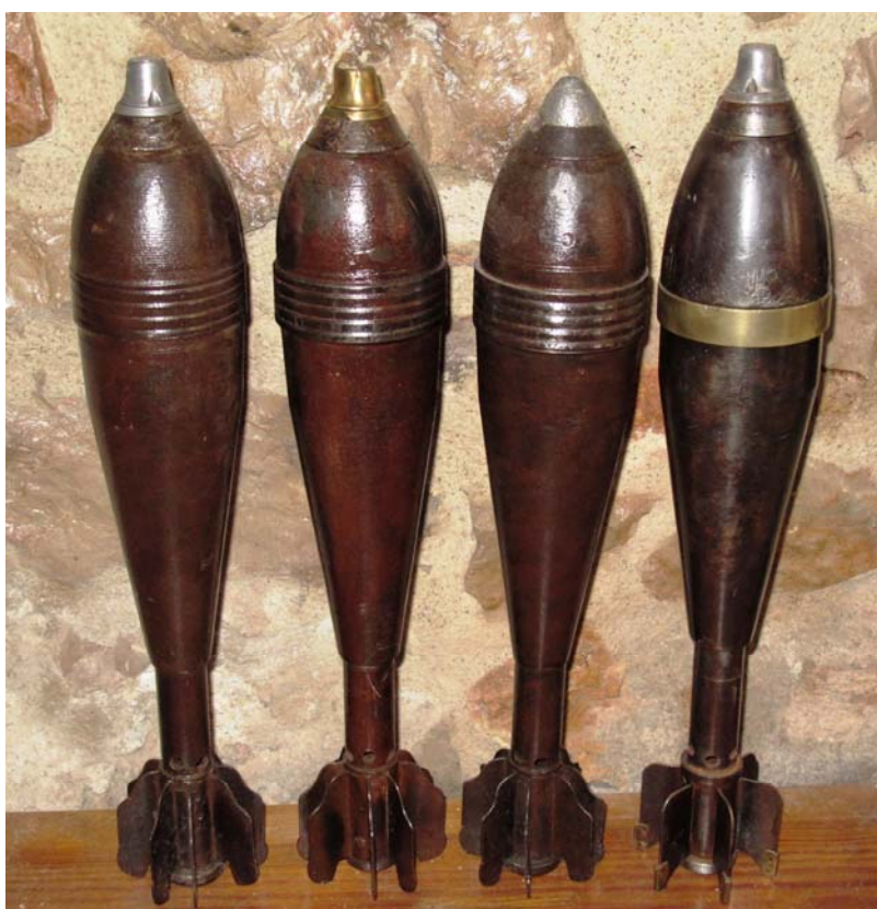
Granadas de mortero Valero reformadas de 81 mm., la tercera, empezando por la izquierda lleva la espoleta Vall, que no tiene el sistema R.S.A.
