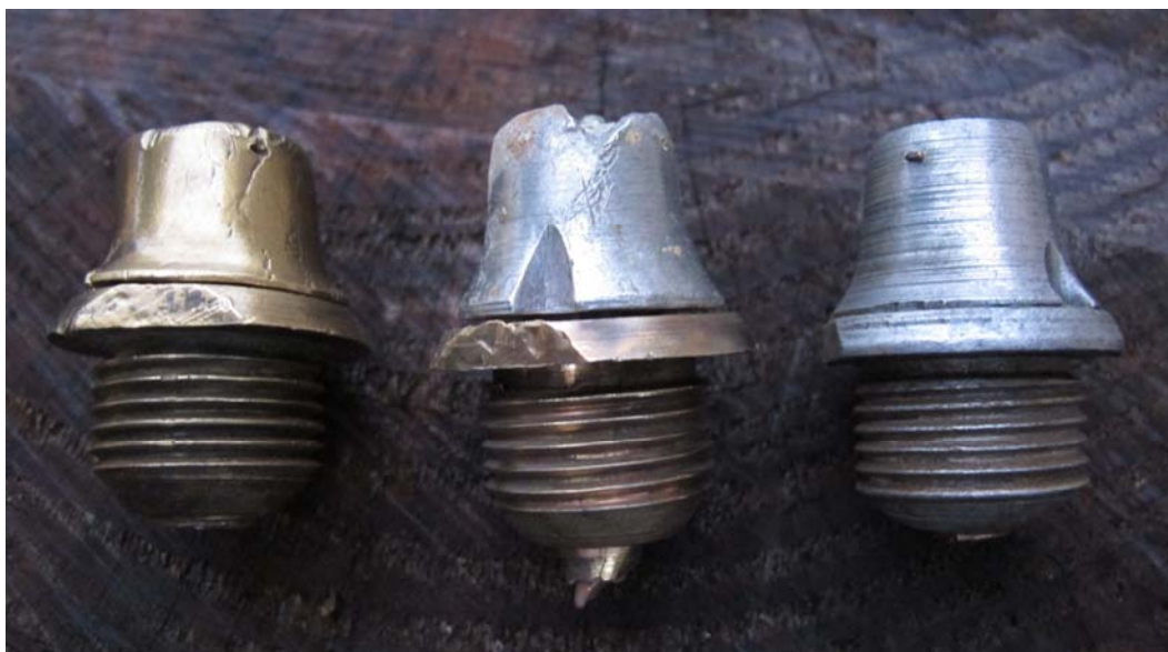
Espoleta Sylvia totalmente de latón, a la izquierda, con la boquilla de latón la cabeza de aluminio, centro; y a la derecha, la espoleta Sylvia normal
