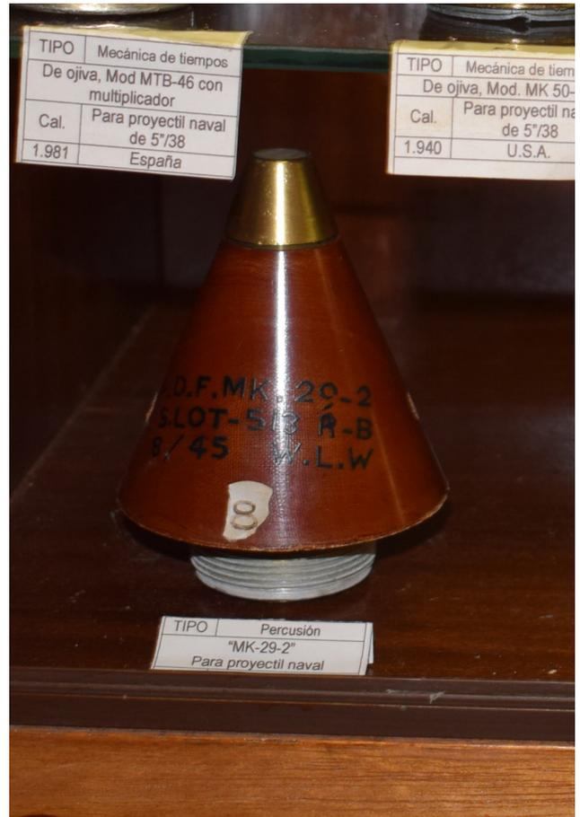
cambia la ojiva de metal, que portaba la original, por una de plástico impregnada de resina para adaptarse mejor a los proyectiles de uso naval y hacerla estanca a la humedad.
