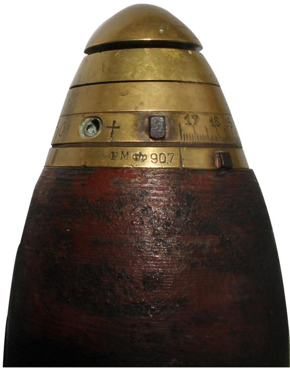
Espoleta de doble efecto, de 17 segundos, modelo 1907 colocada en un proyectil de metralla de 75 milímetros.
