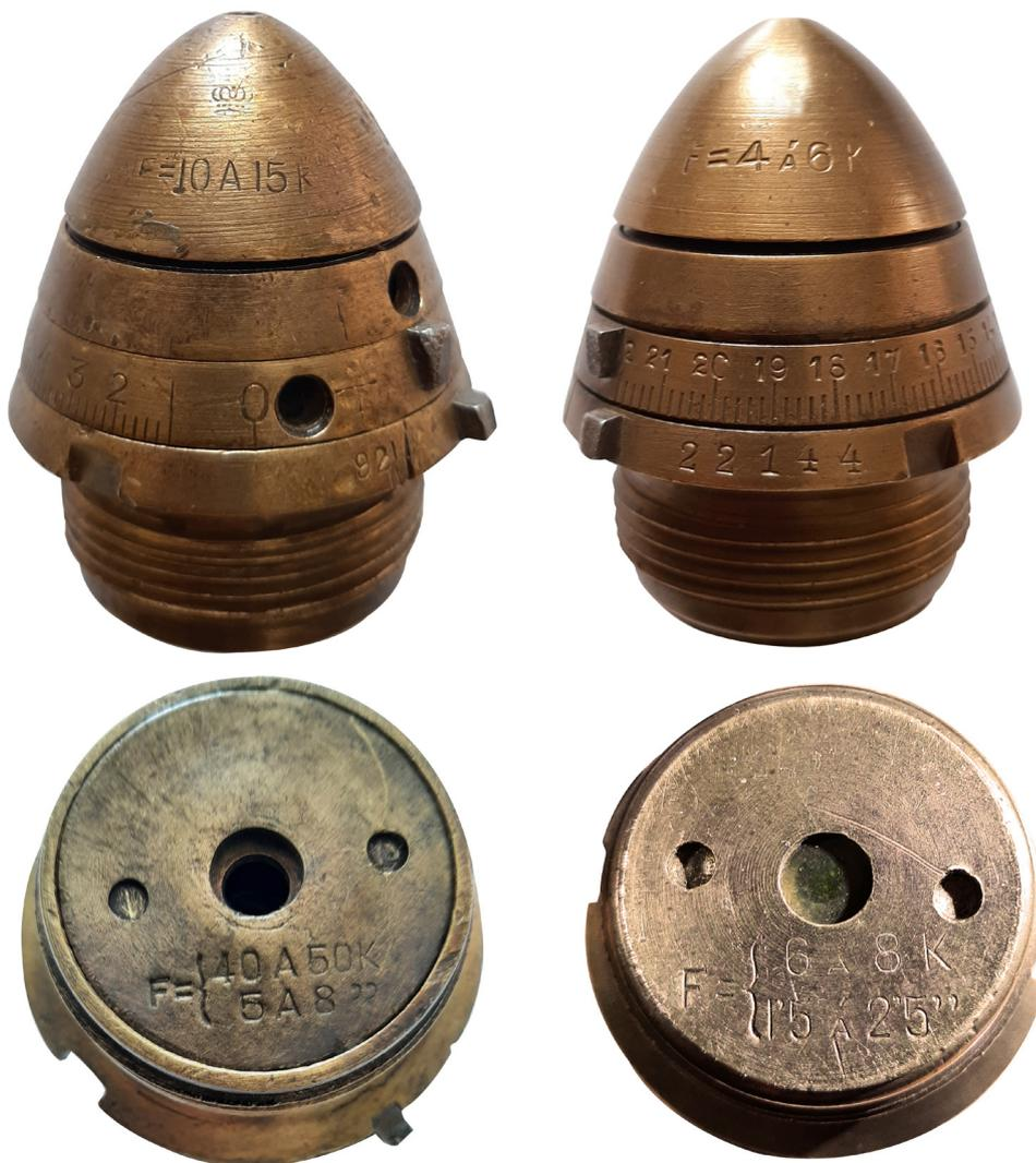
Distintas marcas que llevaban grabadas las espoletas de doble efecto, de 22 segundos, modelo 1911, para ser usadas en obuses o cañones.
