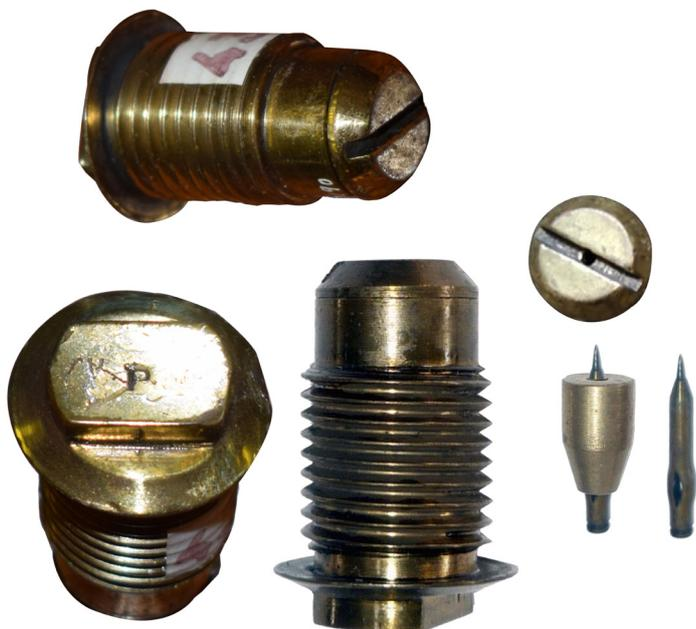
Espoleta de culote modelo Hotchkiss expuesta en el Museo donde se pueden observar sus mecanismos interiores.
