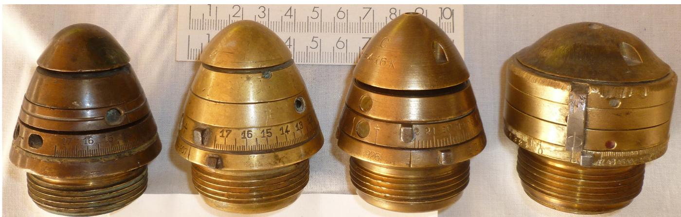
Espoletas de doble efecto usadas antes de la Guerra Civil. De izquierda a derecha: De 17" modelo 1896, de 17" modelo 1907, de 22" modelo 1911 y de 47" modelo 1913.
