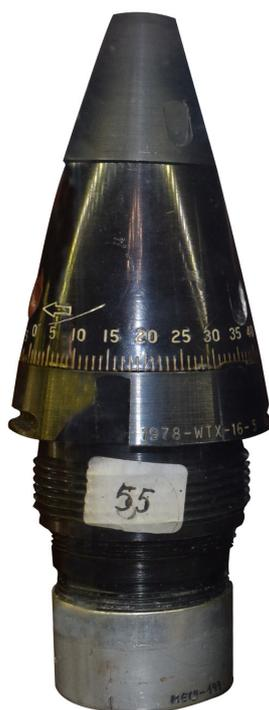
Diseñada para sustituir a las espoletas de la serie M520 y dotarlas de una temporización mayor, ya que la que tenía esta última, 75 segundos, resultaba insuficiente. En este modelo la temporización máxima era de 100 segundos, y llevaba grabado en su cuerpo la numeración de 0 a 100, marcada cada 5 segundos. En su casquillo inferior lleva estampado una escala auxiliar o nonius y una línea índice que indica la graduación de la espoleta.
